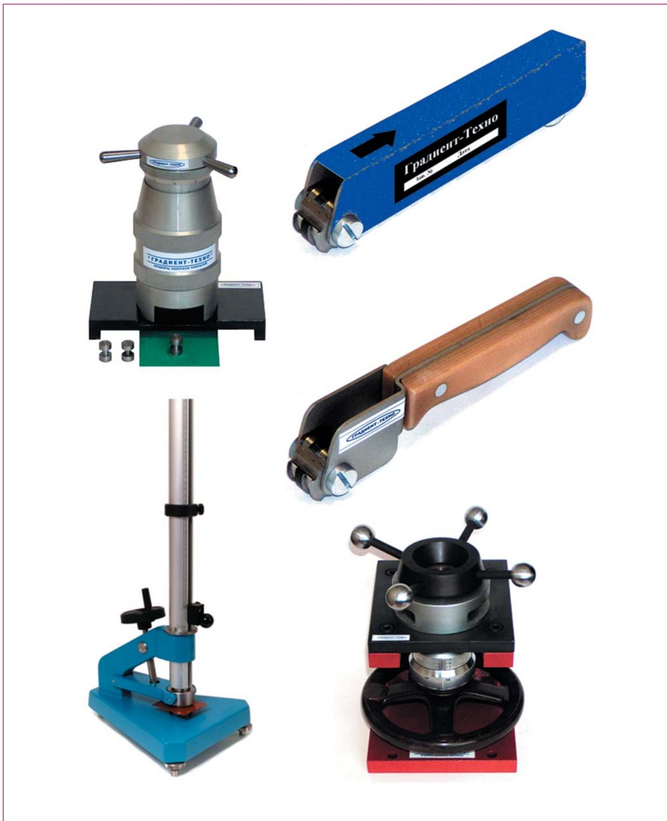
Измерение адгезии методом отрыва оптимально подходит для комплексной оценки качества подготовки поверхности изделий перед нанесением и оценки качества температурно-временного режима отверждения ПК.
