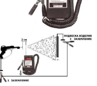
Предприятие Градиент-Техно является разработчиком и производителем прибора Трибоэлектротестер. Прибор предназначен для контроля работоспособности оборудования нанесения порошковых и жидких покрытий методами электростатического и трибостатического нанесения.
